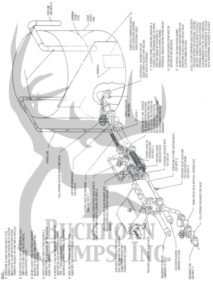
SUGGESTED PIPING SYSTEM FOR PLUNGER PUMPS
